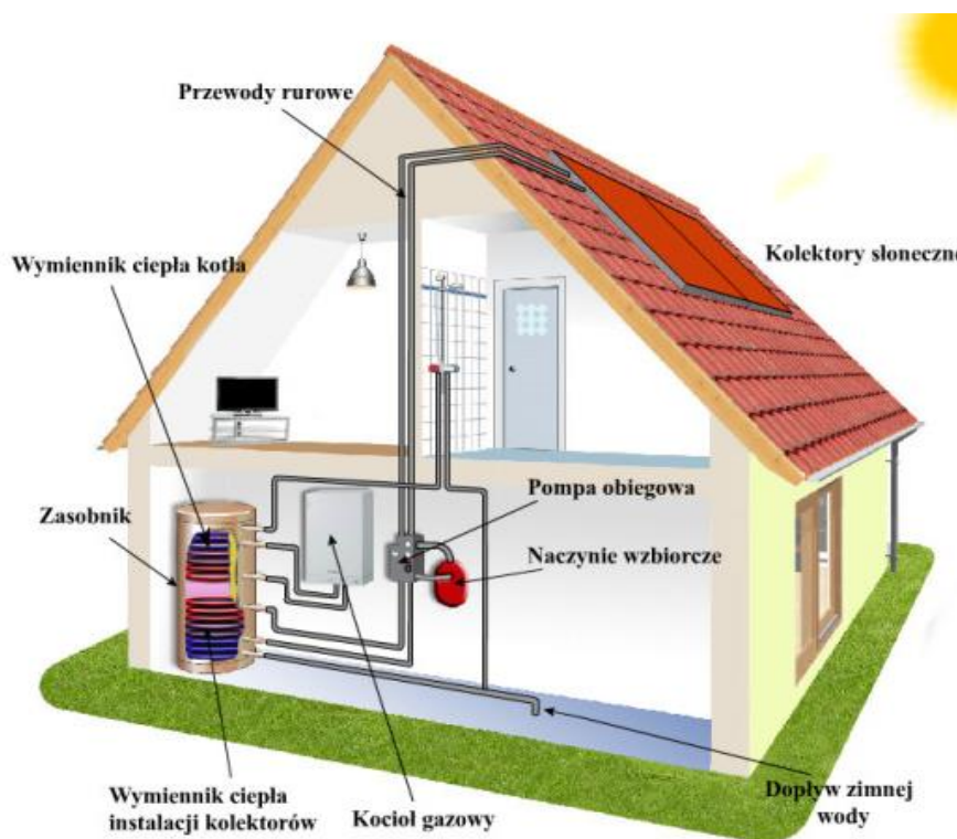
Ryc. 18. Schemat instalacji kolektorów słonecznych w domu jednorodzinnym
